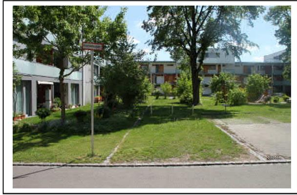
Bereits bestehende Flächen mit Schotterrasen genießen Bestandsschutz, sofern sie für eine Befahrung mit den Fahrzeugen der Feuerwehr geeignet sind.
